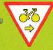
Tourne-à-droite cycliste (placé près d'un feu tricolore)
