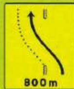
Présignalisation de changement de chaussée
